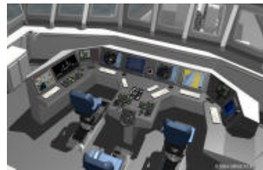
Hoher Automatisierungsgrad – Darstellung „Integrierte Brücke“ auf den Korvetten der Klasse 130
